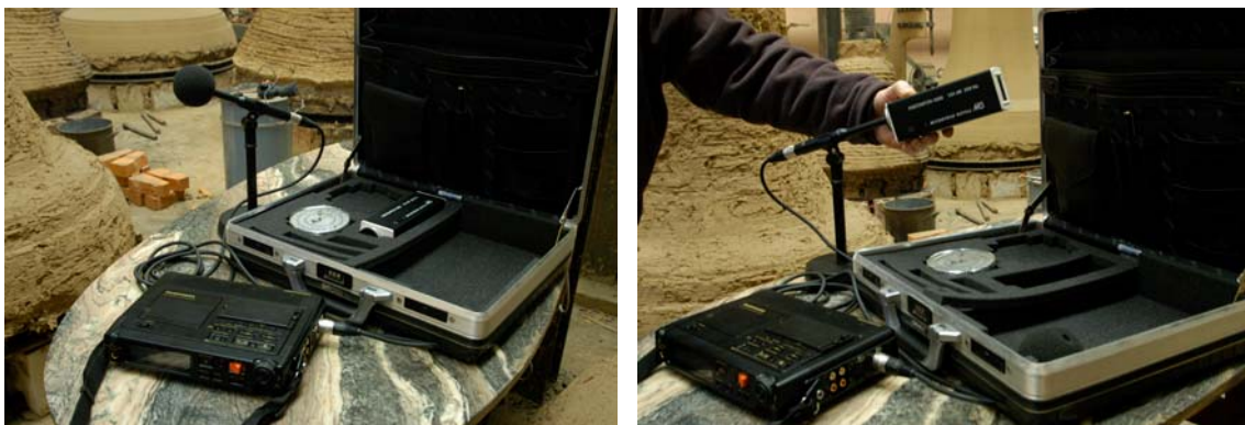
Abbildung 2: Messbereites Equipment, Kalibrierung
